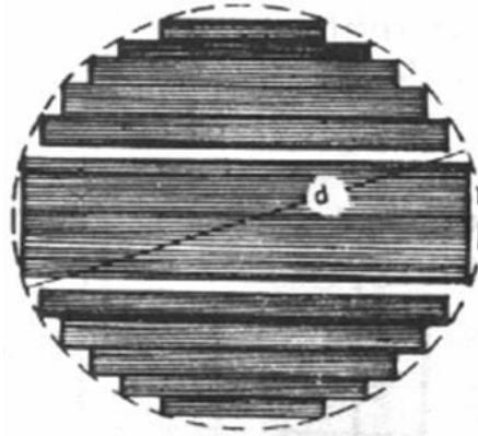
Slika 13. Poprečni presjek magnetnog jezgra<sup>5</sup>
