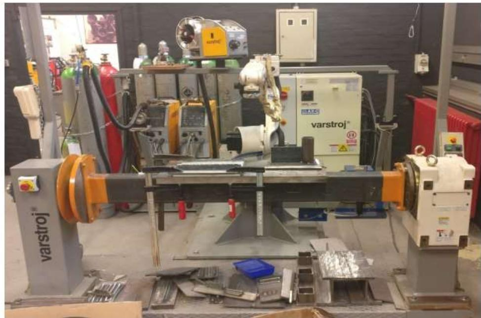
Slika 22. Konfiguracija robotske stanice u Laboratoriju za zavarivanje
