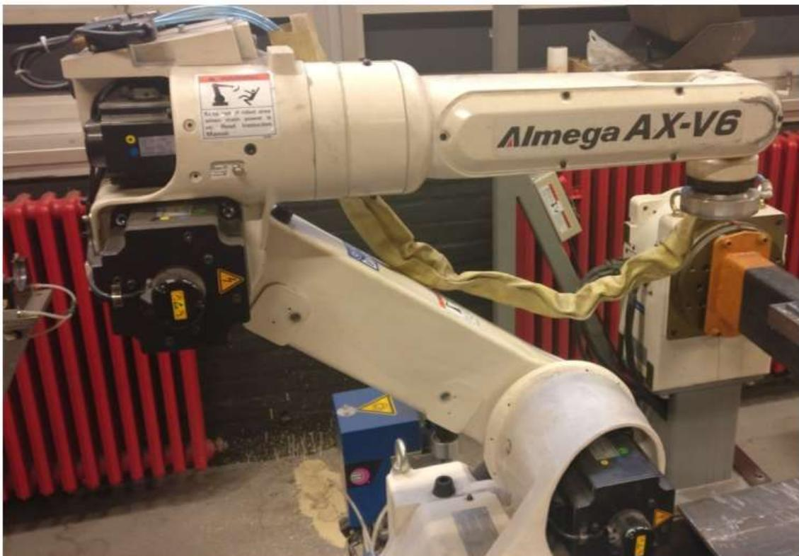
Slika 23. Robot za zavarivanje Almega AX-V6
