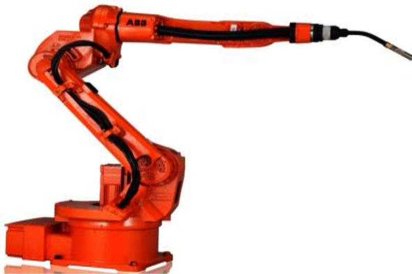
Slika 7. Robot za zavarivanje tvrtke ABB
