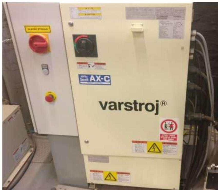
Slika 27. Električka i upravljačka jedinica AX-C
