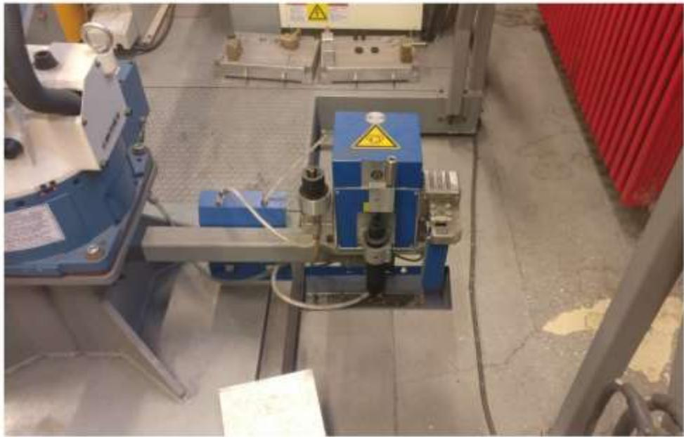
Slika 30. Sklop za čišćenje pištolja za zavarivanje
