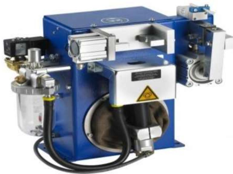
Slika 13. Sistem za čišćenje pištolja
