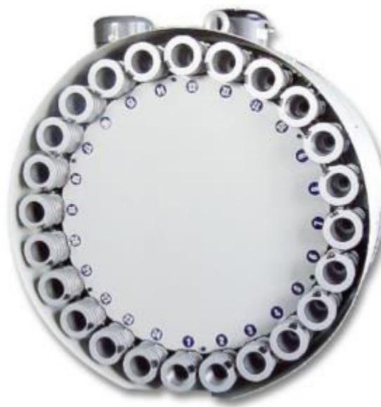
Slika 6 Disk magazin alata
