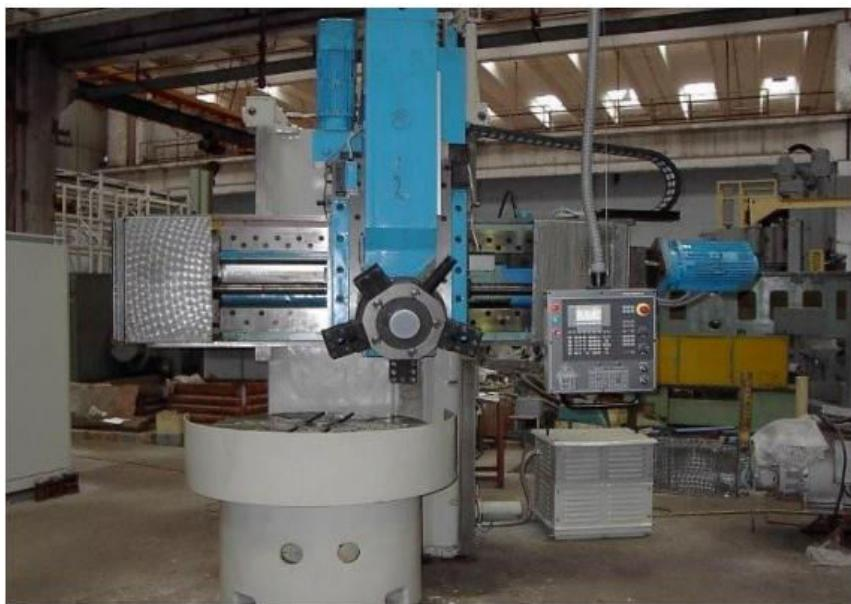
Slika 29. Vertikalna tokarilica<sup>16</sup>
