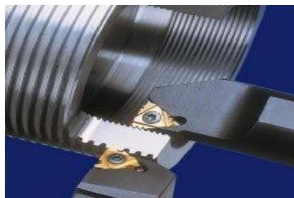
Slika 32. Tokarenje vanjskog i unutarnjeg navoja<sup>16</sup>
