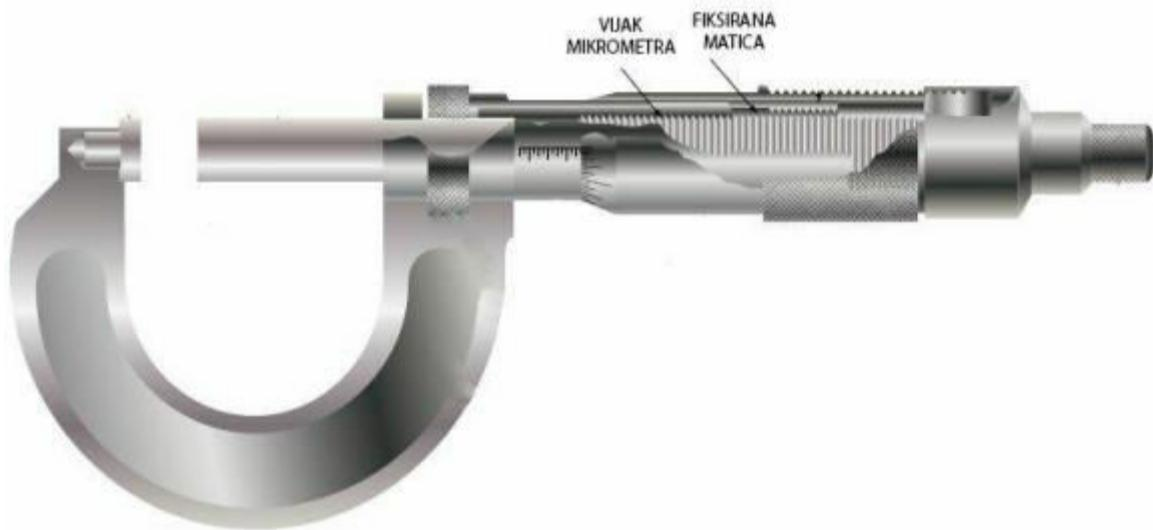
Slika 18.Presjek mikrometra
