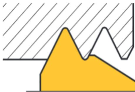
Slika 25. Rezna pločica za puni profil <sup>11</sup>
