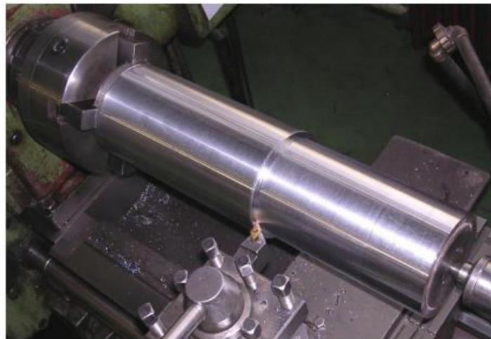
Slika 30.Uzdužno vanjsko tokarenje<sup>16</sup>
