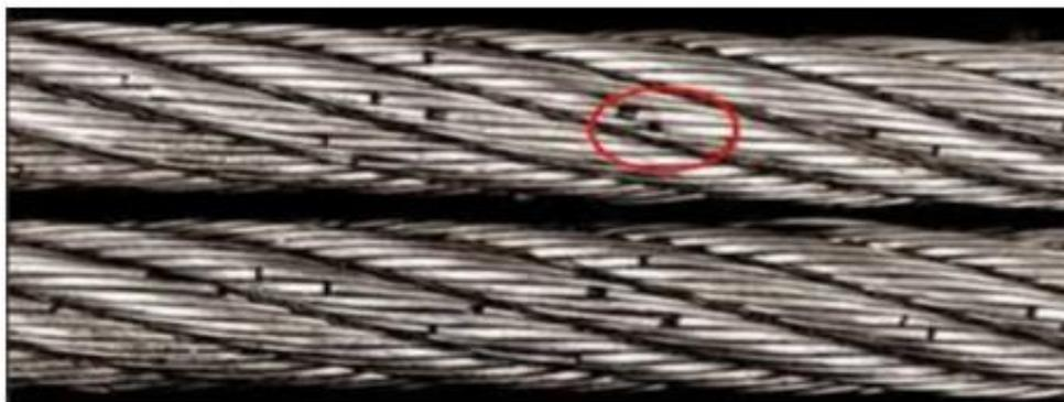
*Slika 10. Savojni lom umora materijala užeta s spojnim nitima.*
