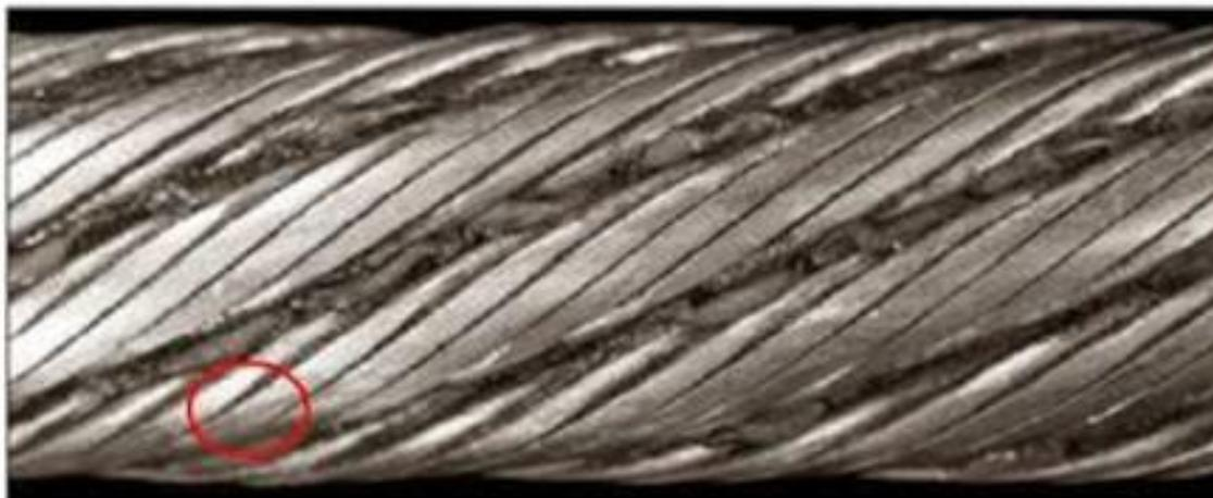
*Slika 9. Mehaničko trošenje čeličnih žica bez pojave unutarnjih pukotina.*
