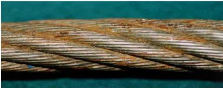
*Slika 11. Korozijski oštećeno čelično uže*
