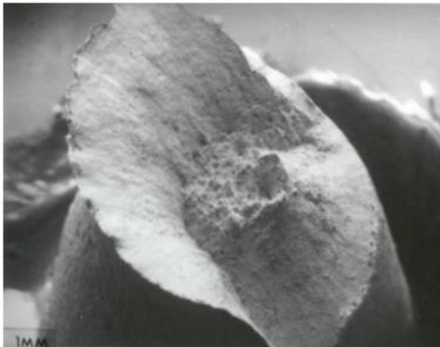
*Slika 12. Tipičan duktilni lom završen konusnim smicanjem*
