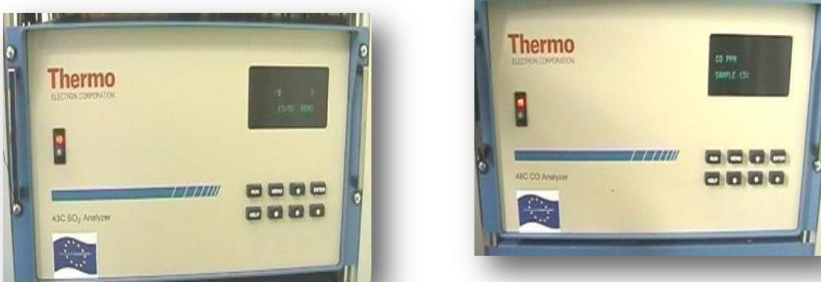
**Slika 9.** Analizatori za sumpor dioksid, azotne okside, ugljen monoksid i ozon<sup>25</sup>
