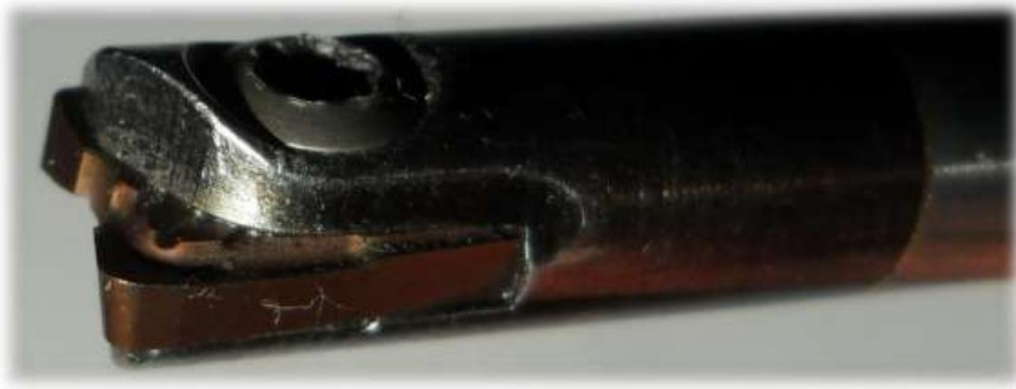
Slika 8.2. Glodalo promjera 10mm i radijusa oštrica R1
