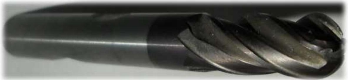
Slika 8.3. Glodalo promjera 10mm i radijusa oštrica R5
