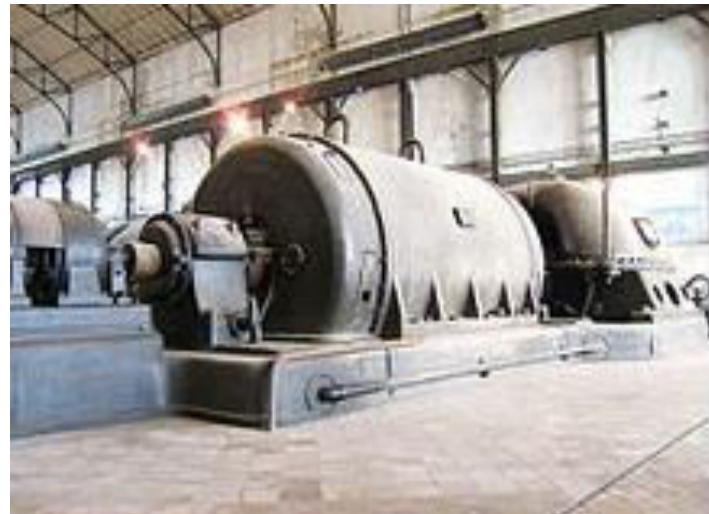
Slika 6. Primjer ranog turbogeneratora, lijevo se vidi i uzbudnik (GanzGenerator u Zwevegemu, Belgija)<sup>10</sup>
