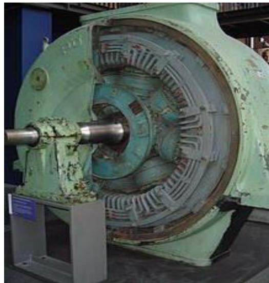
Slika 5. Izmjenični sinkroni električni generator s četiri para polova na rotoru<sup>9</sup>
