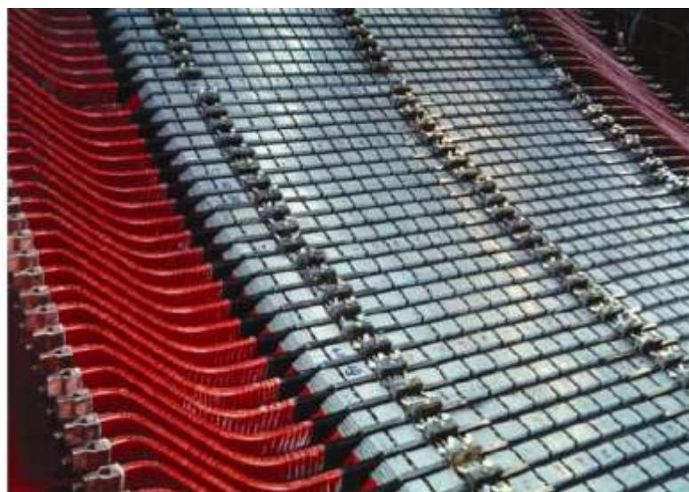
Slika 1.3. Stator sinhrone mašine
