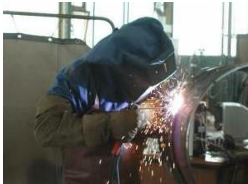
Sl.3. Zavarivanje cijevi REL postupkom
