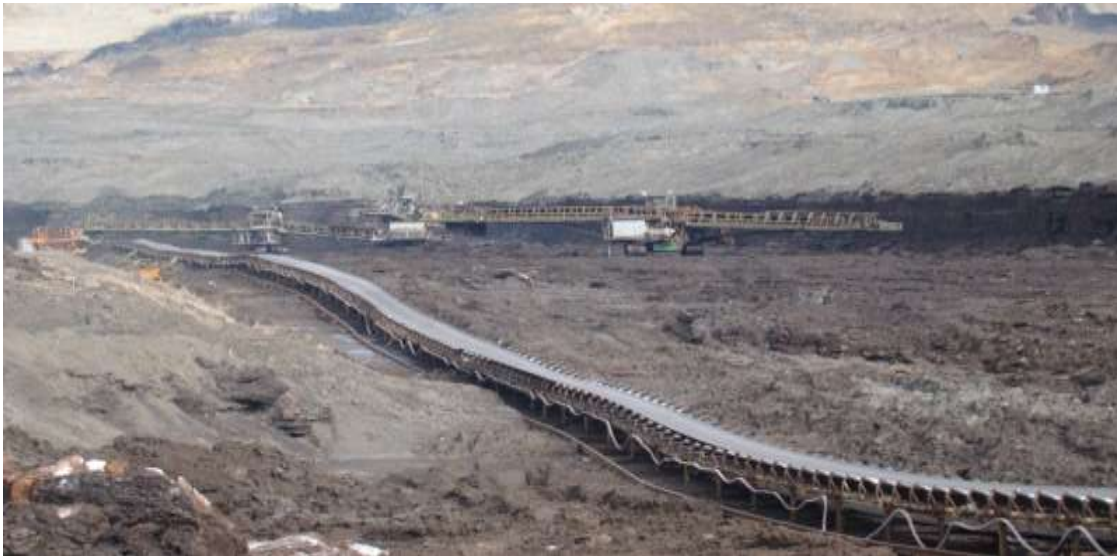
Slika 10. Gumeni transporter za transport uglja 18
