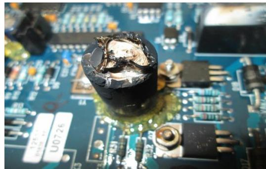
Plovilo na kojem je nastala šteta udarom groma je Jenneau Prestige 46. Prilikom pregleda utvrđena su oštećenja na električkim i električnim uređajima i opremi. Preporučen je popravak i zamjena prema pravilima struke.
